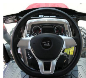
Рис. 2-42. Консоль комбинации приборов
